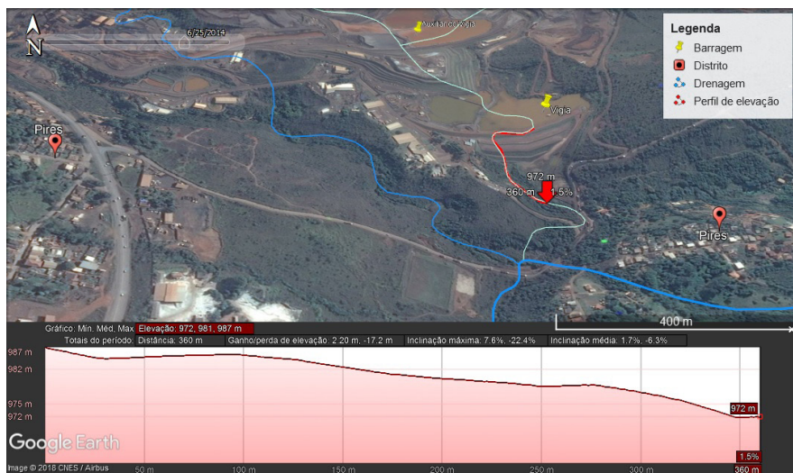
Figura 6.21 - Provável fluxo de lama conforme drenagem da região e o perfil de elevação (ponto mais alto do talude e a ocupação urbana mais próxima), em caso de ruptura das barragens Vigia e Auxiliar do Vigia.
