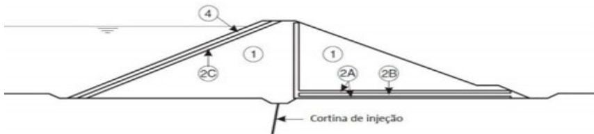
FIGURA 2.2 – Barragem de terra homogênea com filtro vertical e tapete horizontal
