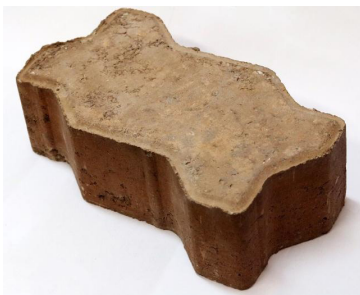
Figura 4 - Paver intertravado produzido com RBMF em substituição à 80% da areia.
