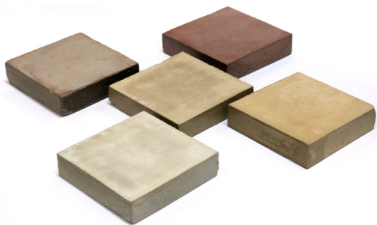
Figura 5 – Exemplos de ladrilhos produzidos com diferentes proporções de RBMF e pigmento de RBMF.
