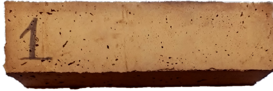
Figura 7 – Geopolímero produzido com RBMF e resíduo de lâ de vidro.
