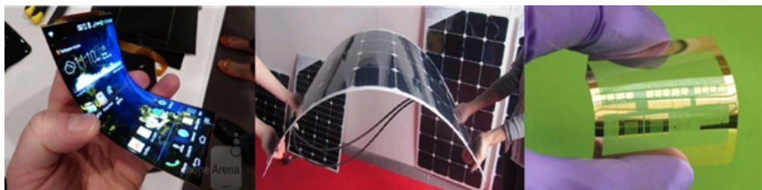
Figura 7 - Dispositivos confeccionados utilizando-se polímeros semicondutores
