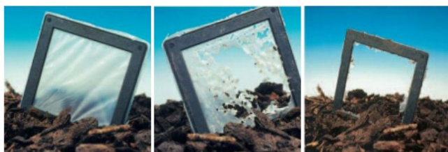
Figura 17 - Estágios de biodegradação de um filme de PBAT em solo, durante 4 semanas
