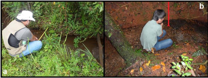
Figura 3.2: Demonstração da medição da largura (a) e da profundidade no canal de drenagem (b)
